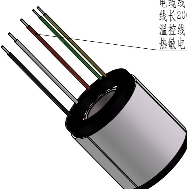
电缆线: #24AWG 红, 白, 黑, 对应U、W、V
